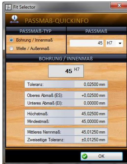
DIESE EXTRA-FUNKTION DIENT ZUR SCHNELLEN ANZEIGE DER ABMAßE FÜR EIN BESTIMMTES PASSMAß.
