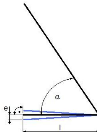
BEI DER BERECHNUNG DER ALLGEMEINTOLERANZEN FÜR WINKELMAßE (FÜR WINKEL A) ERFOLGT ZUSÄTZLICH DIE BERECHNUNG DER MAXIMALEN LOTRECHTEN ENDABWEICHUNG (MAß E) FÜR DEN KÜRZEREN WINKELSCHENKEL (MAß L).
