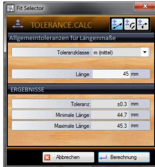
MIT TOLERANCECALC BERECHNEN SIE ALLGEMEINTOLERANZEN NACH DIN ISO 2768-1 WAHLWEISE FÜR LÄNGEN, FÜR RADIIEN BZW. FASEN ODER FÜR WINKELMAßE.
